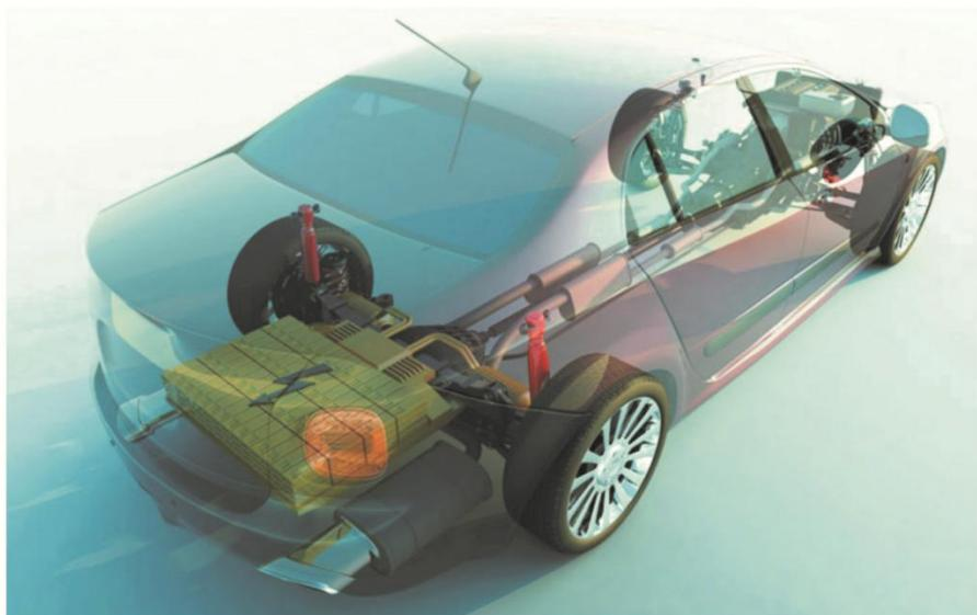
电动汽车锂电池防火需要建立具有战略纵深的多道防线。除了电池内部尽可能使用不可燃或难燃材料让电池具有本质安全性能外，电池外部的第一道防线是防止发生导致电池过热着火的各种诱因，比如过充、短路、撞击、进水等，这就需要对电气及机械系统进行安全设计。当第一道防线被突破后（比如电池管理系统发生故障未能及时切断充电电源），电池温度升高，监控系统中的温度传感器或气体、烟雾探测器等应及时发现故障并报警，提醒工作人员处理故障，消除火灾诱因，此为第二道防线。
